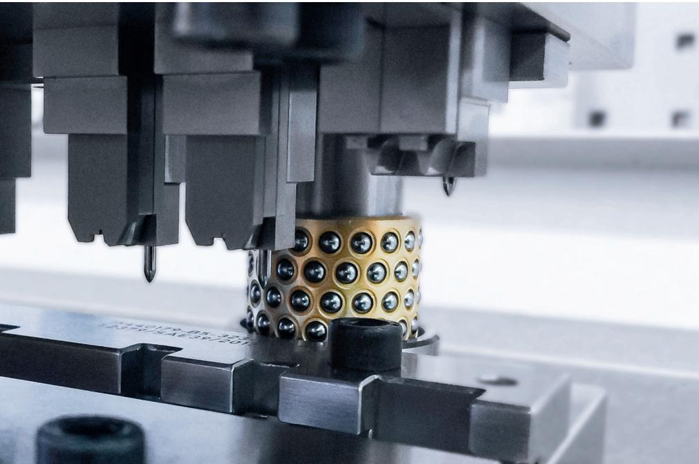
**Kugelführung:** Dank Inhouse-Fertigung kann Steinel den Herstellungsprozess lückenlos kontrollieren. © Steinel
